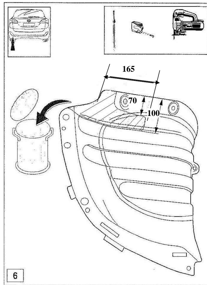
Рис.3 Вырез в пластиковой защите для а/м
