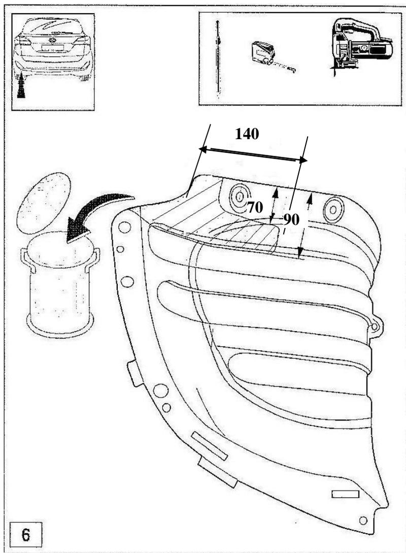
Рис.2 Вырез в пластиковой защите для а/м
