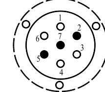
**Примечание.** На прицепах других производителей может использоваться контакт 5 для подключения габаритных огней и освещения номерного знака.
