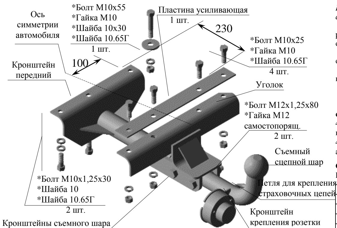
Рис.1 Тягово-сцепное устройство ТСУ ДЭУ МАТИЗ.
